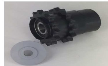
DKK 1/2" Z=14 dub labyrinth (art 78000101) Kunststof rol Ø50x2,8 vv kunststof DKK ketting wiel met stofkap labyrinth
